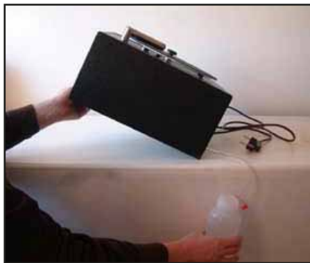
Fot. 5. Opróżniania zbiornika wewnętrznego.
